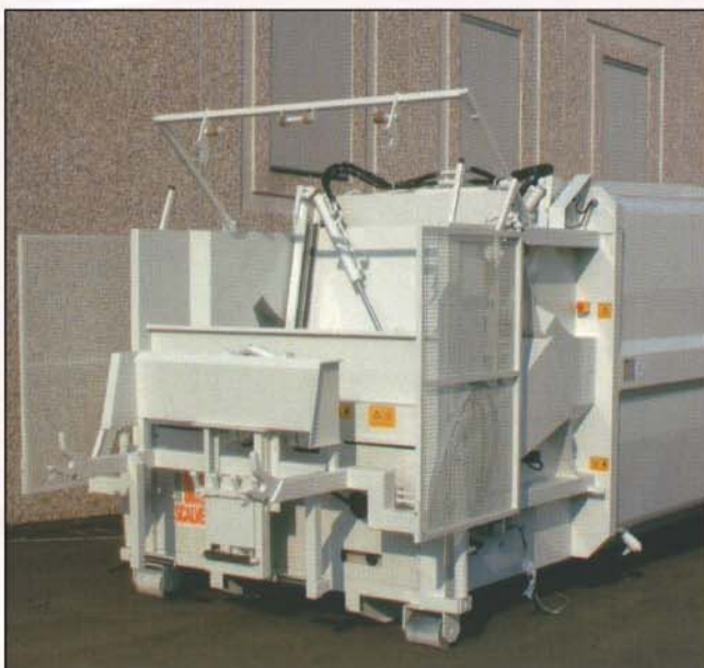
Compacteur monobloc à pelle CMS 100 équipé de lève-conteneur avec préhension DIN.
