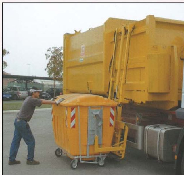
Compacteur monobloc avec fonctionnement sur camion et lève-conteneur.
